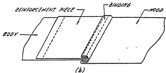
HOOD - NECK JOINING SEAM (OPERATION 12 OF TABLE II)
